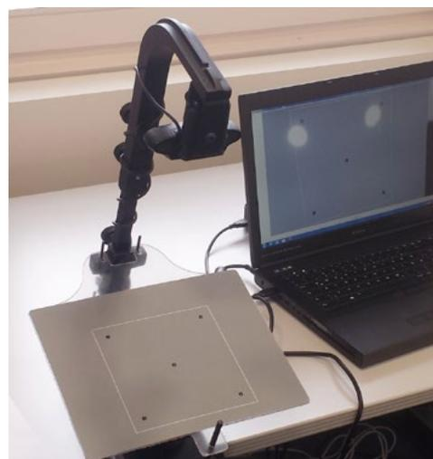
*Mithilfe des DHBW-eigenen Tobii Pro X2-60 Eye Trackers, welcher auf dem Mobile Device Stand montiert wurde, konnte der Blickverlauf der Probanden aufgezeichnet werden. Gleichzeitig filmte eine Kamera den Bildschirm des Smartphones (hier Abbildung des Kalibrationsgitters), um eine Auswertung der Daten zu ermöglichen.*
