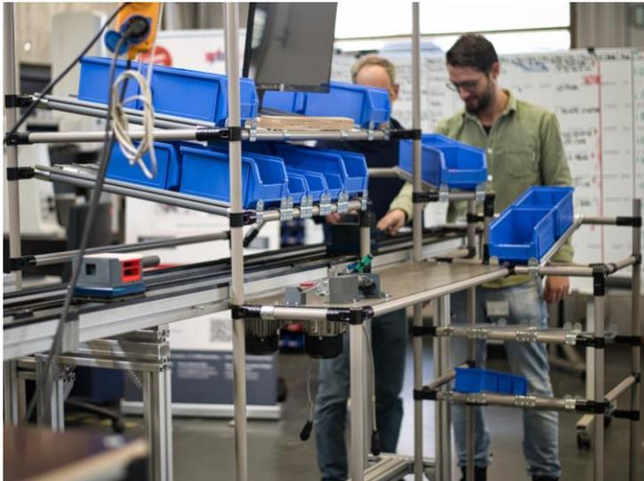
Die Produktion in der Zukunftsfabrik Bodensee verfolgt das Konzept der Kreislaufwirtschaft. Eine Arbeitsstation ist dabei für manuelle Montageprozesse ausgerichtet und mit einem Werkerassistenzsystem ausgestattet.
