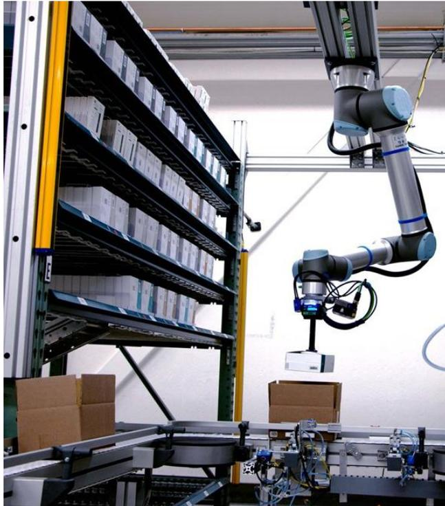
In Station 1 des I4.0 Produktionssystems sollen bedarfsgerecht Werkstückträger auf das Bandsystem positioniert werden. Ziel ist es den Demontageprozess im Produktionssystem abzubilden.
