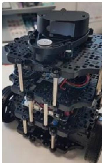
Mit Turtlebots (kleinen mobilen Robotern) werden Szenarien wie autonomes Einparken, Signalerkennung und Tunneldurchfahrten erprobt.
