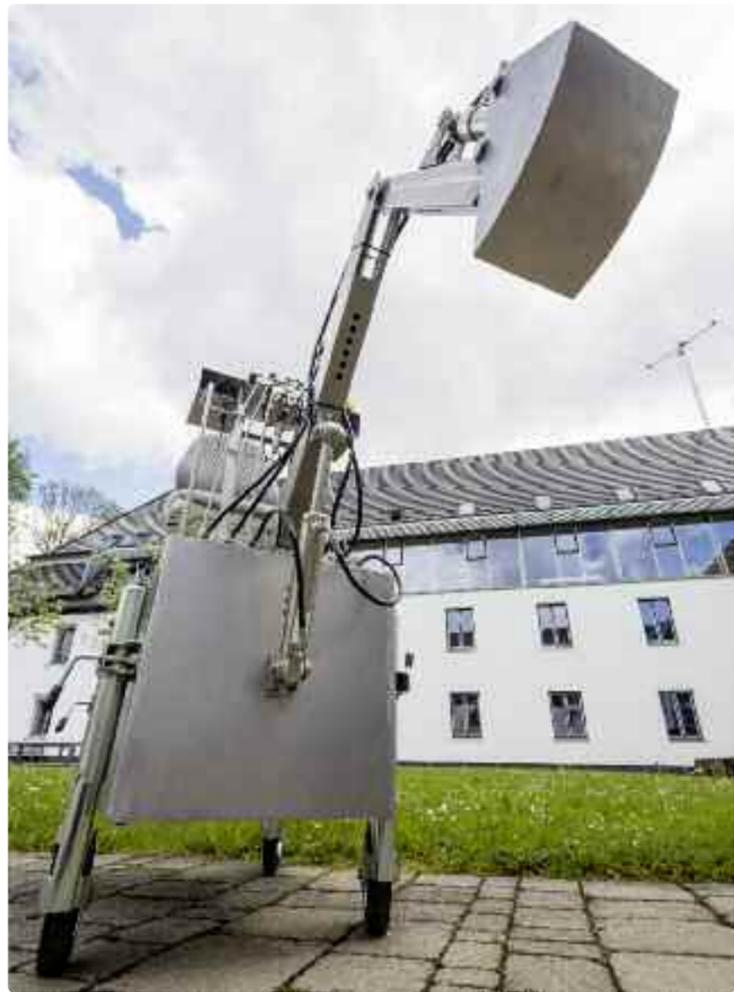
Voilà: Der Wasserhydraulik-Bagger „Made im Fallenbrunnen“.
