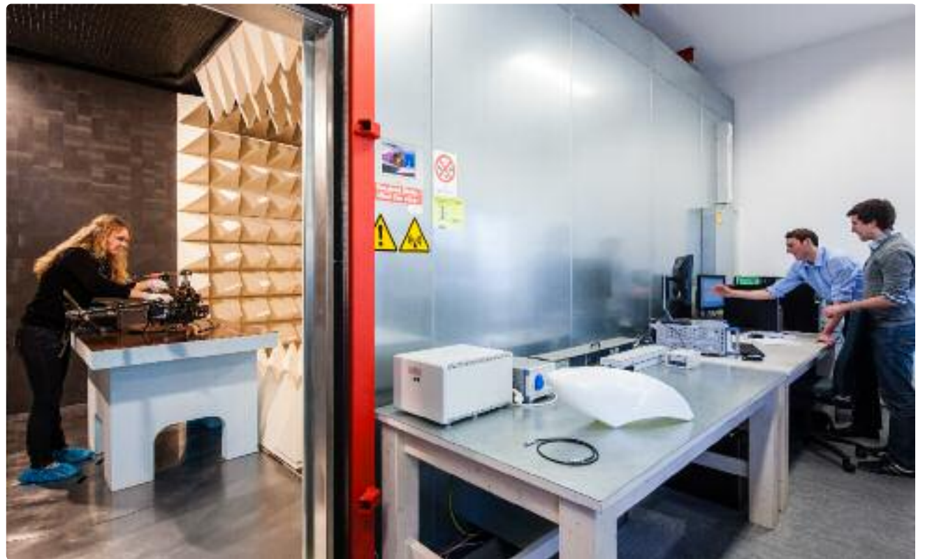
Im Labor für elektromagnetische Verträglichkeit wird überprüft, wie elektronische Geräte auf elektromagnetische Effekte reagieren.
