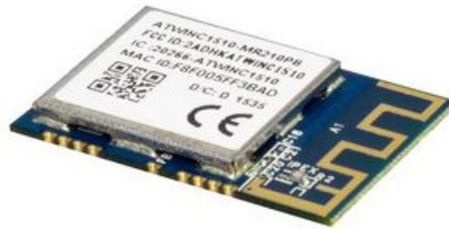
**Abbildung 19: WLAN-Modul (Quelle: [www.farnell.com](http://www.farnell.com))**
